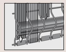
Glisser les lattes verticales à partir du haut du panneau en les positionnant derrière les profilés en «V», puis bloquer les lattes dans les clips comme spécifié sur le schéma. Placer ensuite les deux lattes verticales plus étroites sur les extrémités du panneau. Pour finir placer le profil de finition sur le haut du panneau.
