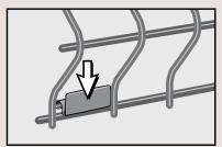
Placer les clips sur le fil horizontal du bas comme représenté sur le schéma.
