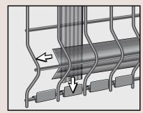
Placer les profilés en «V» dans les plis du panneau. Placer ensuite 2 lattes verticales à 1 m de distance pour bloquer les profilés horizontaux.
